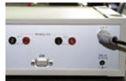
T995 USB Interface und skalierbarer Analogausgang (0 - 1 Volt) USB-Interface and scaleable analogue output (0 - 1 Volt)
